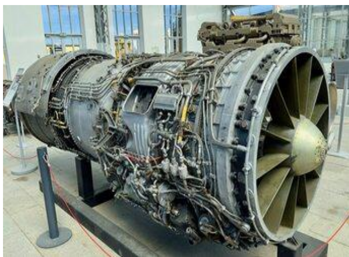
Рисунок 74. Авиационный турбореактивный двигатель семейства АЛ-7 с форсажной камерой, созданный в ОКБ А.М. Люльки
