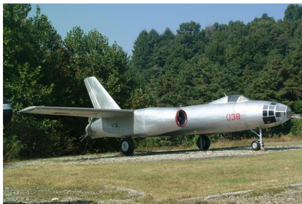
Рисунок 68. Ил-28 – один из первых серийных советских самолётов с реактивными двигателями ВК-1 (он же РД-45)
