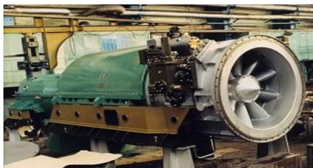
Рисунок 88. Газовая утилизационная бескомпрессорная турбина
