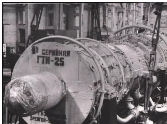
Рисунок 102. Газоперекачивающий агрегат мощностью 25 МВт (ГТН-25-1)
