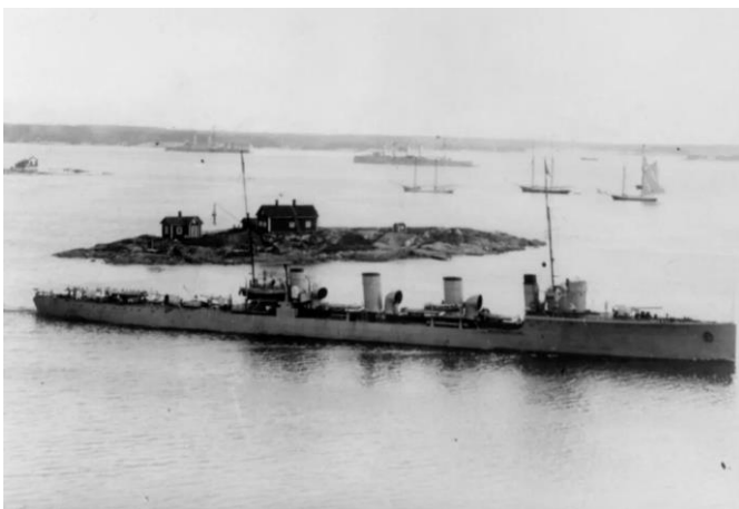
Рисунок 32. Эскадренный миноносец «Новик» – первый турбинный эсминец российского флота, спущенный на воду 21 июня 1911 года
