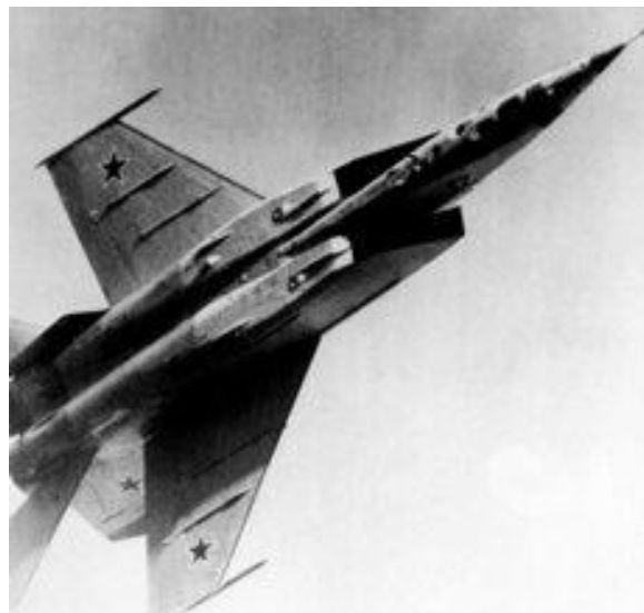
Рисунок 91. Советский двухместный сверхзвуковой высотный всепогодный истребитель-перехватчик дальнего радиуса действия. Разработан в ОКБ-155 на базе МиГ-25 в 1970-х годах. Первый советский боевой самолёт четвёртого поколения
