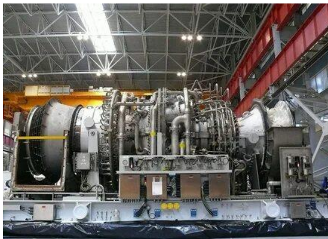
Рисунок 125. Т-32 в составе ГПА-32 «Ладога»
