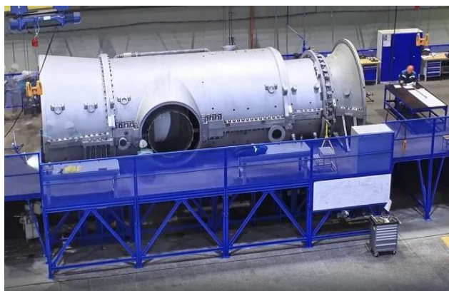
Рисунок 142. Газовая турбина ГТЭ-170.1 производства «Силовые машины»
