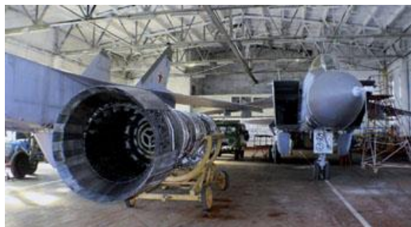
Рисунок 99. Двигатель Д-30Ф6 на МиГ-31
