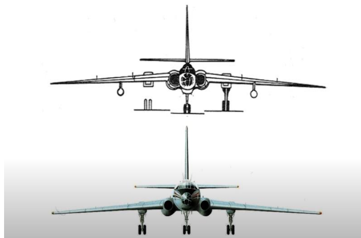
Рисунок 70. Ту-16. Советский тяжёлый двухмоторный реактивный многоцелевой самолёт. Выпускался в различных модификациях, включая бомбардировщик, ракетноносный вариант, самолёт-заправщик, самолёт РЭБ и другие.
