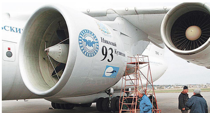
Рисунок 124. Двигатель НК-93 на летающей лаборатории
