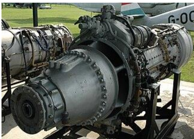
Рисунок 75. АИ-20 – одновальный авиационный турбовинтовой двигатель
