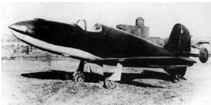
Рисунок 60. Ракетный самолёт, первый советский самолёт с жидкостным ракетным двигателем. Моноплан с низкорасположенным крылом
