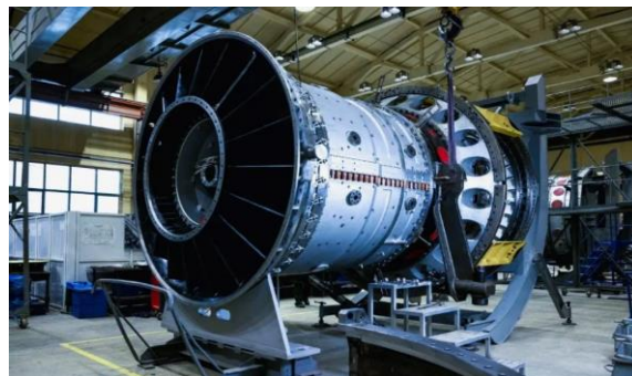
Рисунок 114. ГТД-110М газотурбинный двигатель в классе мощности 110 МВт
